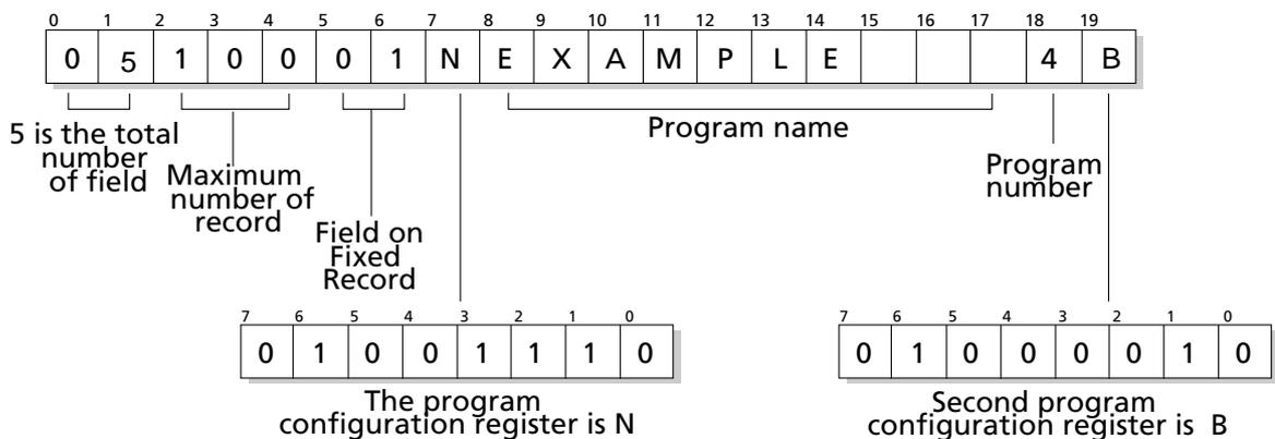
Il Field Definition Record del record fisso di testata deve avere la seguente struttura:
