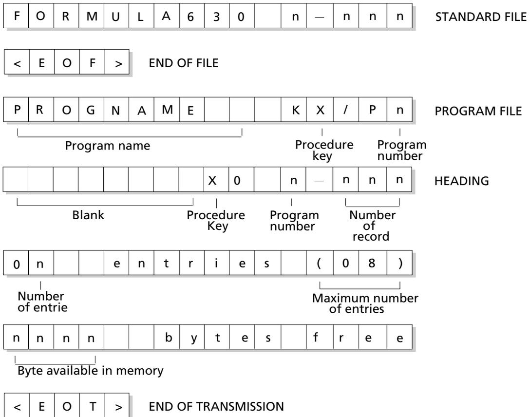
Poiché l'utilizzo di 630E2.HEX non prevede l'esistenza del file standard "FORMULA630", il primo record inviato durante la trasmissione è vuoto e inutilizzabile. Nel caso in cui l'host computer richieda un file di programma, la struttura del frame di comunicazione trasmesso, è la seguente:
