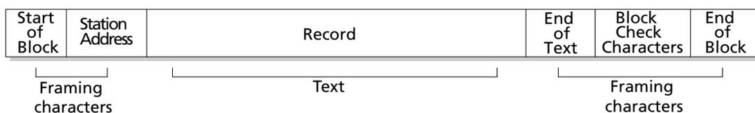
La figura mostra la posizione di ciascun carattere che costituisce il frame di comunicazione dell'informazione da trasmettere o da ricevere.
