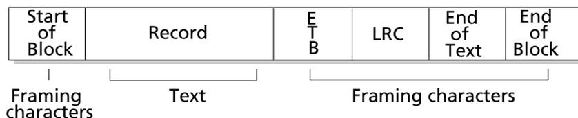
La figura mostra la posizione di ciascun carattere che costituisce il frame di comunicazione dell'informazione da trasmettere.
