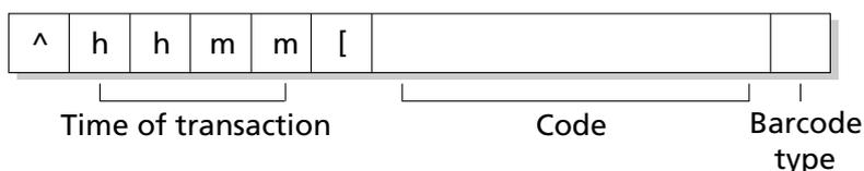
Nella modalità SPECIAL PROTOCOL, diversamente dalle altre modalità d'utilizzo, l'ultimo byte del record contiene un "Barcode type", cioè un carattere che identifica il tipo di codice letto.
