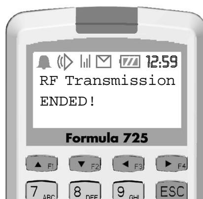
Se una trasmissione dovesse fallire, il terminale Formula 725/RF emette tre segnali acustici, e sul display compare quanto indicato in figura.
