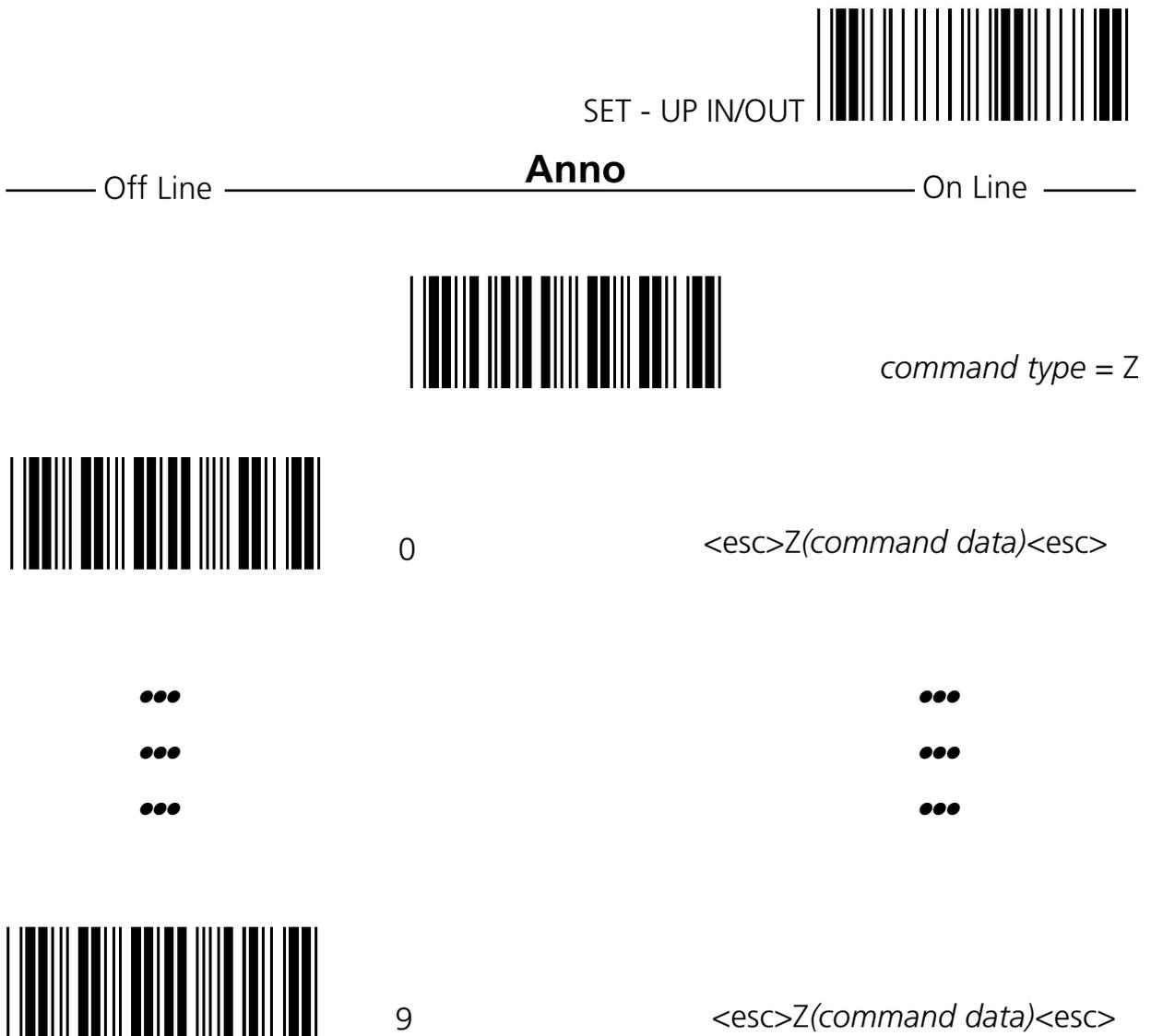
Questo parametro permette di impostare il valore degli anni nella forma "aa"; ad esempio, per impostare l'anno "96", in configurazione Off-Line è necessario effettuare la scansione del codice 9 e poi del codice 6. In configurazione On-Line è necessario digitare il comando `<esc> Z96<esc>`.
