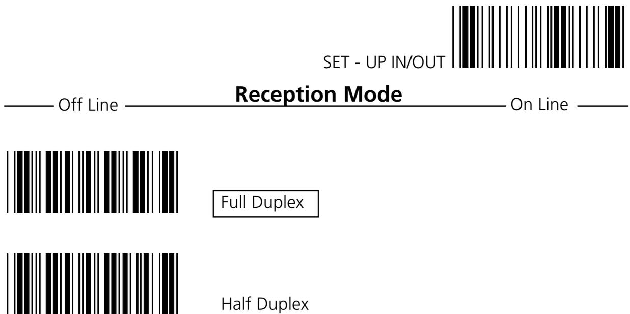
E' possibile configurare questo parametro solo nella configurazione Off-Line. Nella modalità di comunicazione Full Duplex il terminale Formula può ricevere dati e trasmetterli contemporaneamente; invece, nella modalità di comunicazione Half Duplex, il terminale Formula non può ricevere dati mentre li trasmette, di conseguenza i dati inviati vengono persi. La modalità di comunicazione Full Duplex non può essere utilizzata con collegamento RS-485.
