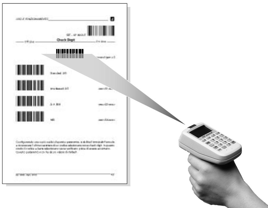
Effettuare la scansione dei codici di parametrizzazione che si vogliono configurare. Sul display rimane scritto il codice di famiglia e di volta in volta che si effettua la scansione comparirà il relativo codice di parametrizzazione.
