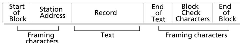
La figura mostra la posizione di ciascun carattere che costituisce il frame di comunicazione dell'informazione da trasmettere o da ricevere.
