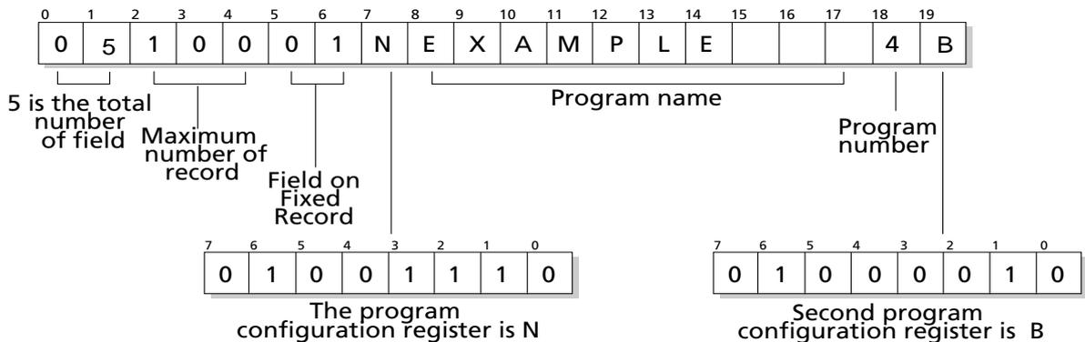
I Field Definition Record del record fisso di testata deve avere la seguente struttura:
