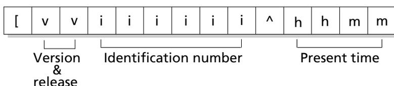
Il numero di identificazione è costituito dai primi 6 caratteri del parametro "Start Of Text". Poiché questo parametro non è configurabile questo campo è riempito di spazi, carattere ASCII 20<sub>16</sub>. Si ricorda che per il primo record il carattere "Start Of Block" è sempre uguale a <stx> (02<sub>16</sub>).
