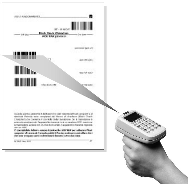
Se necessario, continuare la scelta dei parametri da configurare e la scansione dei relativi codici di parametrizzazione.
