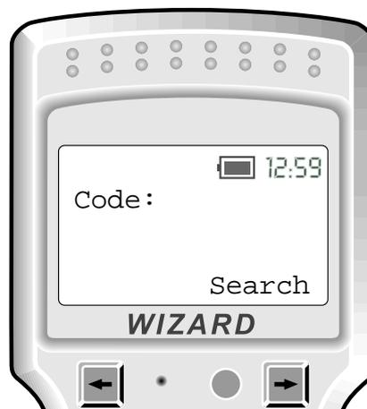
E' necessario inserire il *codice* da cercare e premere <ENTER>, sul display compare quanto indicato in figura.
