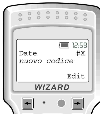
Se il numero di caratteri introdotto è inferiore alla lunghezza del campo, questo viene completato con degli spazi 0 zeri di riempimento.
