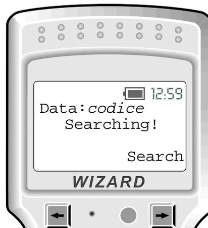
Se il *codice* viene trovato, viene visualizzato sul display del terminale F732 come indicato in figura.
