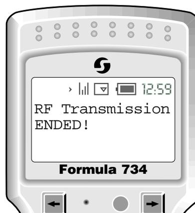
Se una trasmissione dovesse fallire, il terminale Formula 734/A/RF emette tre segnali acustici, e sul display compare quanto indicato in figura:
