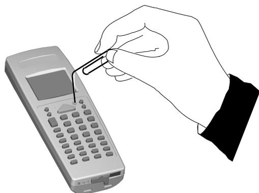
**PULSANTE DI RESET PROTETTO:** per attivare il pulsante di reset, inserire un oggetto smussato nel foro. La funzione di reset cancellerà tutti i dati della RAM.
